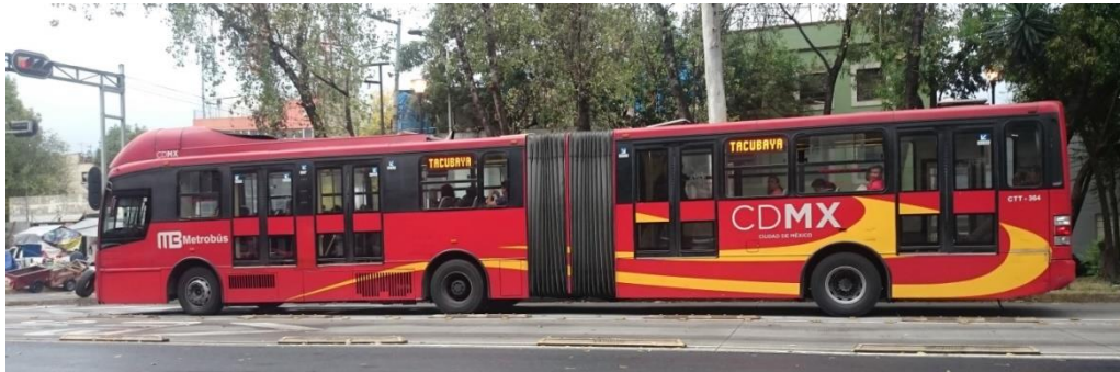
Múltiples puertas para facilitar el ingreso y egreso por parte de los usuarios al autobús. Autor: Antonio Carlos González Coronado.
