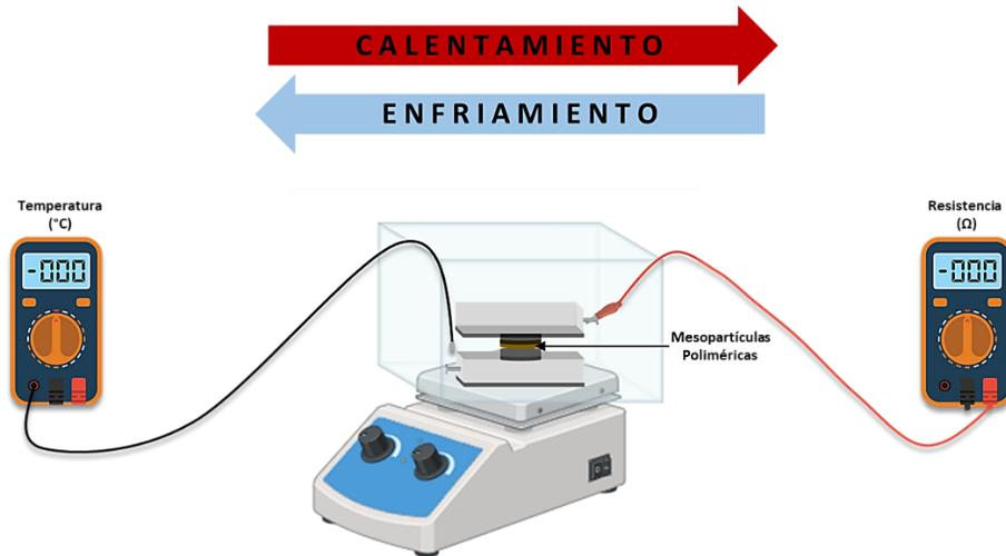
Figura 16. Esquema de celda de monitoreo de la resistencia de las mesopartículas poliméricas en función de la temperatura.
