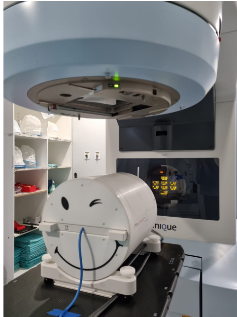
Figura B.4: Colocación del maniquí PTW Octavius 4D sobre la mesa del linac.
