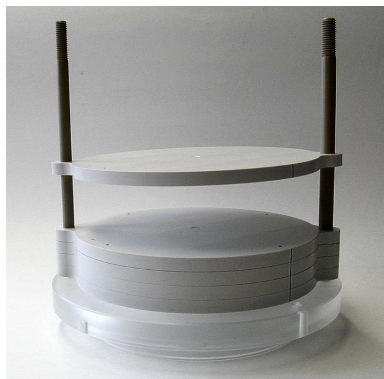
Figura 3.1: Maniquí IMRT de cabeza y cuello, placa base con dos pernos de ajuste y placas de RW3.
