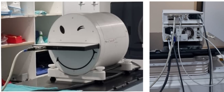
Figura B.5: Manera correcta de colocar los cables.
