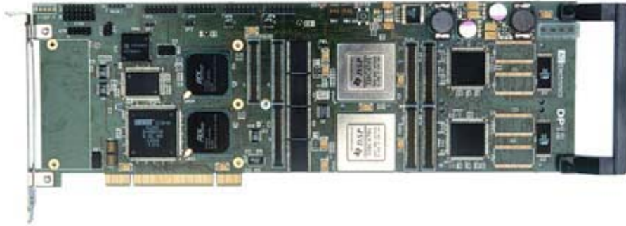
Tarjeta DP12 de AG Electronics. Tarjeta PCI para procesadores duales TMS320C6x con posibilidades de expansión a través del canal PMC PCI mezzanine card.
