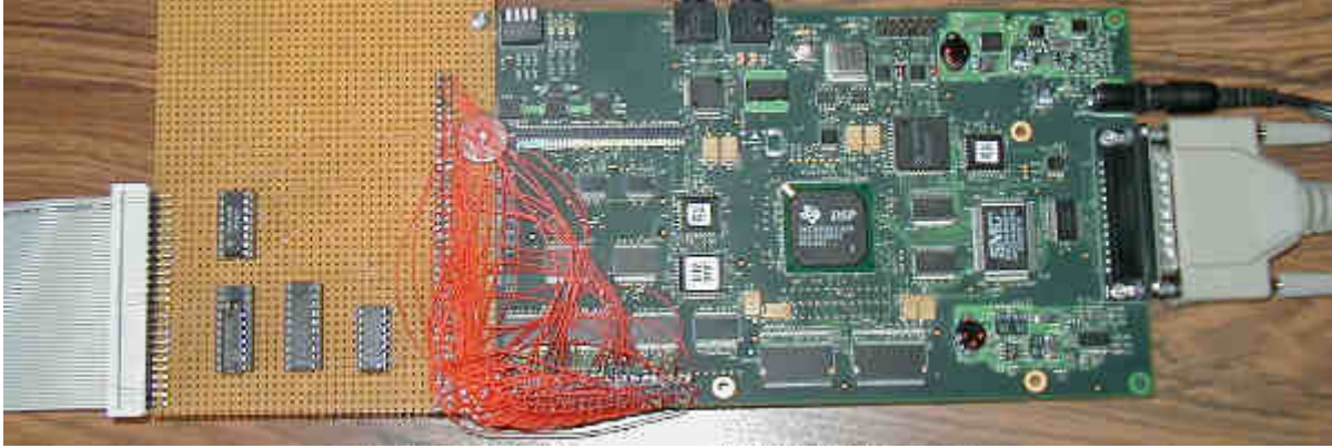
Tarjeta de evaluación del DSP unida por un lado al puerto serie de la computadora para cargar programas específicos para la prueba de la tarjeta, y la conexión a través de lógica convencional a la tarjeta de evaluación del DSP.
