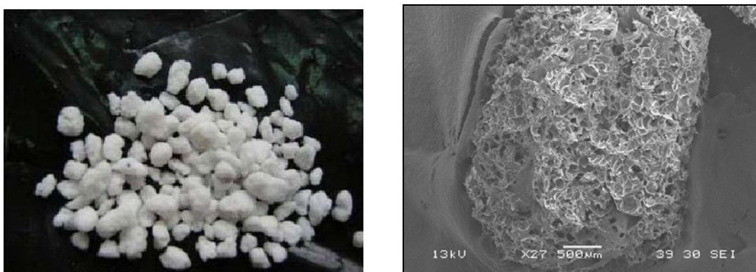
Figura 4.1. Fotografía de Perlita, soporte utilizado en los experimentos de biofiltración.
